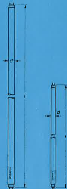
L-Lampe mit 26 mm Ø
